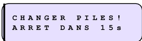
Si les piles de remplacement ne sont pas neuves ou sont d'une autre technologie, l'appareil peut-être mis en marche de manière forcée en appuyant sur la touche dès l'apparition de l'écran.
