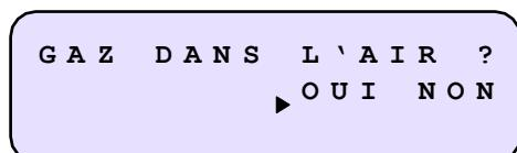
Un appui sur NON lance la procédure de calage du zéro. Un appui sur OUI annule la procédure.
