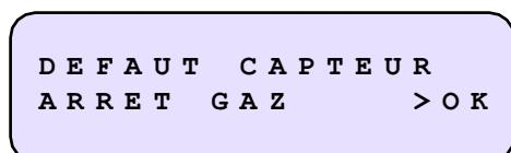
Après acquittement, Le module de détection gaz est désactivé. Un arrêt puis un allumage de l'appareil permettront d'activer à nouveau le module. Le réglage du zéro reste alors inchangé.
