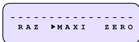
Déplacer la flèche sur ZERO et appuyer sur plus de trois secondes.
