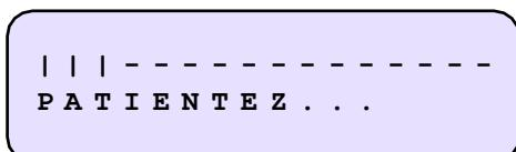
Le bargraph permet de visualiser l'état électrique du capteur pendant sa chauffe.
